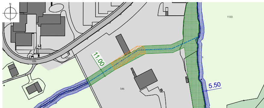
Abb. 17 Planausschnitt «Zonenplan Gewässerraum» Gebiet Campus Süd; blau gepunktet: Freihaltezone Gewässerraum; grün gepunktet: Grünzone Gewässerraum; orange schraffiert: Gewässerraum gemäss symmetrischer Gewässerraumfestlegung
