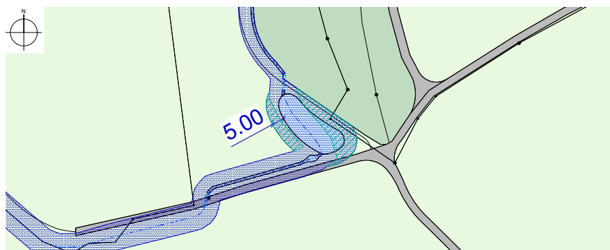
Abb. 16 Planausschnitt «Zonenplan Gewässerraum» Gebiet Ifike; blau punktiert: Freihaltezone Gewässerraum; türkis schraffiert: Fläche, um welche der Gewässerraum erhöht wird
