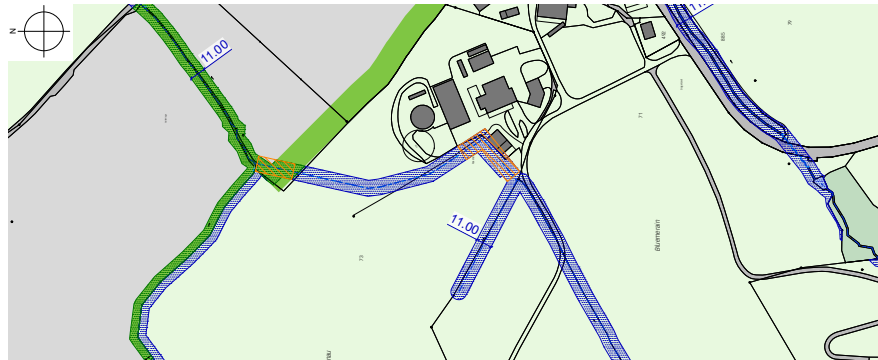
Abb. 19 Planausschnitt «Zonenplan Gewässerraum» Gebiet Bluemerain; blau punktiert: Freihaltezone Gewässerraum; grün punktiert: Grünzone Gewässerraum; grün: Grünzone; orange schraffiert: Gewässerraum gem. symmetrischer Gewässerraumfestlegung
