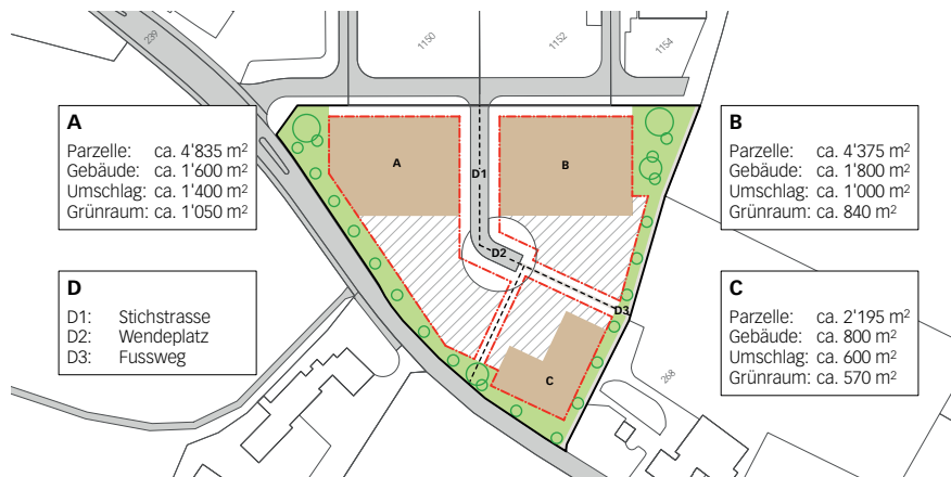
Abb. 8 Grobkonzept zur Bebauung und Erschliessung einer potenziellen Arbeitszonenerweiterung im Gebiet «Länggass» im Rahmen einer späteren OP-(Teil)Revision
