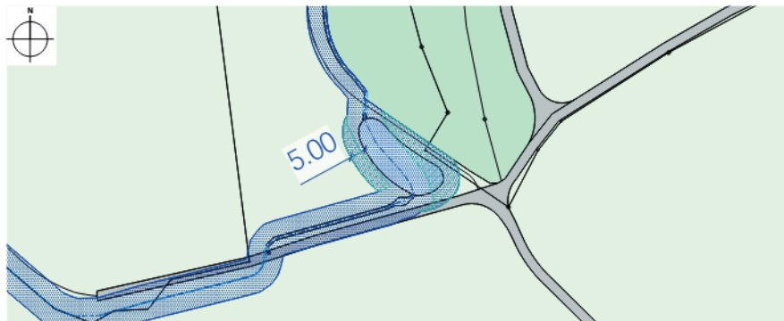
Abb. 19 Planausschnitt «Zonenplan Gewässerraum» Gebiet Ifike; türkis schraffiert: Fläche, um welche der Gewässerraum erhöht wird
