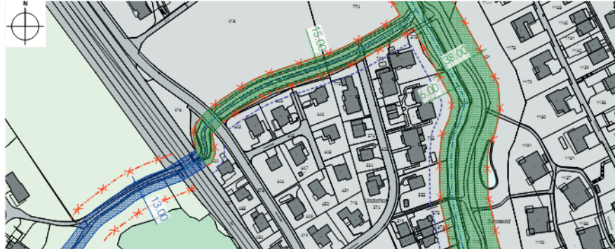
Abb. 27 Planausschnitt «Zonenplan Gewässerraum» Gebiet Underhof; rote Linie: kantonale Baulinie; violette Linie: kommunale Baulinie
